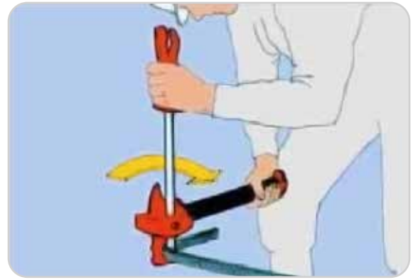
2. Bending flat iron - axe blade.
