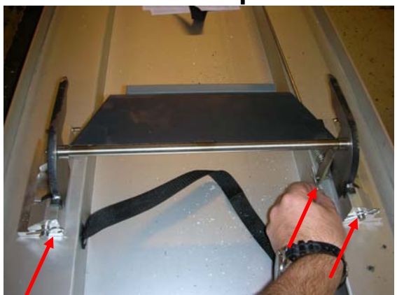
3-sätt tillbaka de 2 låssprintarna
