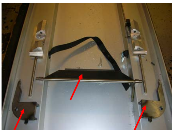
3-Lyft av de 2 låskrokarna samt låsplattan
