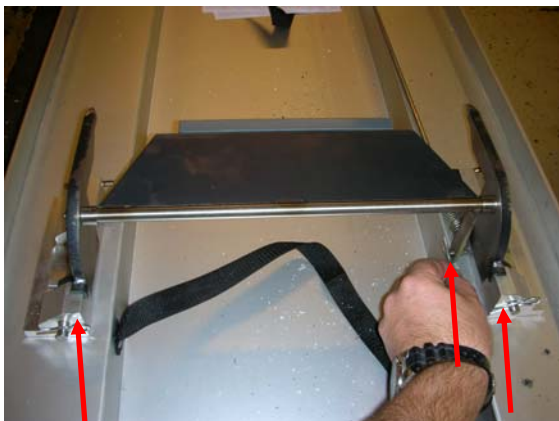
1-Dra ut de 2 låssprintarna, samt haka ur stängen
